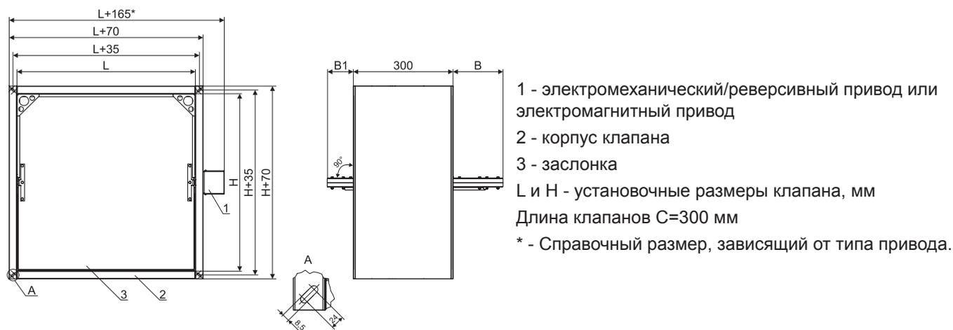
Вылет заслонки за корпус клапана прямоугольного сечения канального исполнения:
