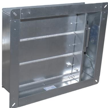
Клапан дымоудаления ДМУ МС (далее клапан) используется в качестве клапана дымоудаления с нормально закрытой заслонкой. Клапан дымоудаления предназначен для открывания проемов вытяжных систем аварийной противодымной вентиляции. Клапан устанавливается в проемах стен, перекрытий, подвесных потолков, а также в торце воздуховодов.
