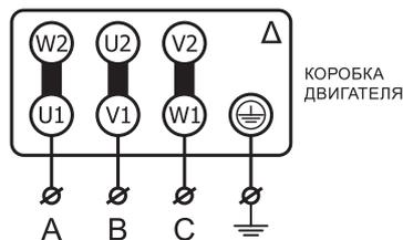
\* В вентиляторах с номинальным напряжением  $\Delta/Y$  380В/660В предусмотрена возможность запуска пониженным напряжением по схеме Y- $\Delta$ . Для получения более подробной информации по подключению, обратитесь в отдел технической поддержки.
