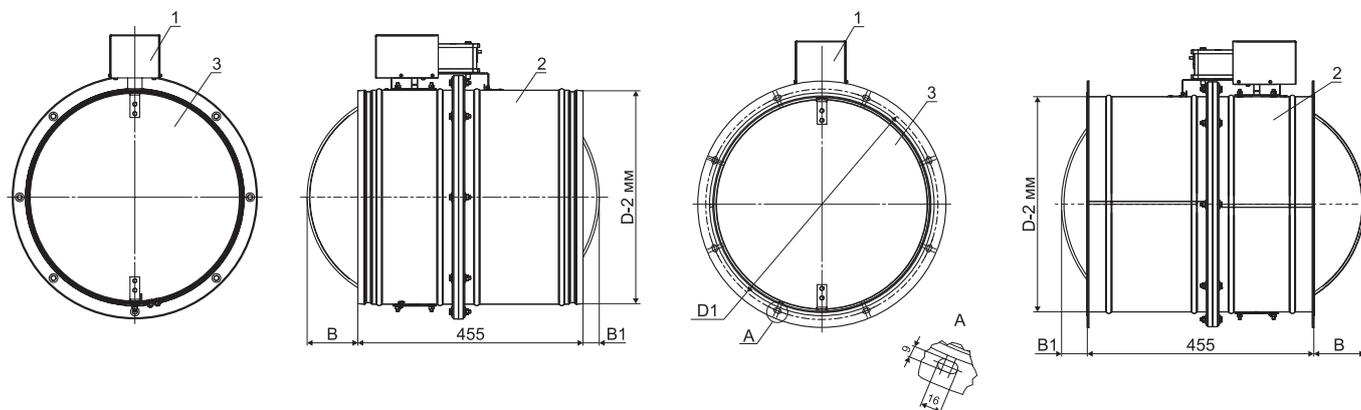
1 - электромеханический/реверсивный привод или электромагнитный привод;
