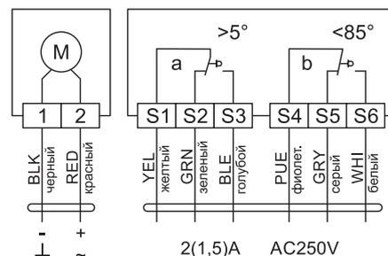
**Электрический реверсивный привод РОВЕН**
