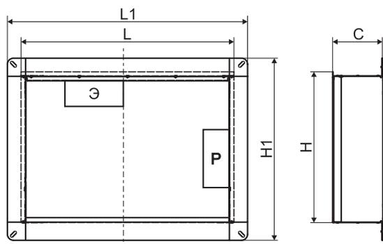
L и H – установочные размеры клапана, мм;
