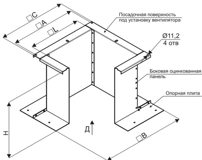
\* Стакан опорный монтажный COM-1-O-AF, в зависимости от заказа, может комплектоваться: клапаном на приток (КП) или клапаном ОЗ.
