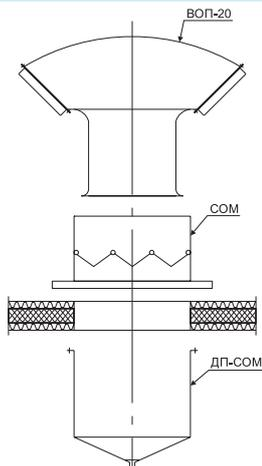
Схема установки вентилятора ВОП-30 на стакан опорный монтажный СОМ с установкой дренажного поддона
