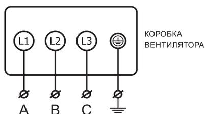
Электрическая схема подключения вентиляторов с номинальным напряжением  $\Delta/Y$  380/660В\*
