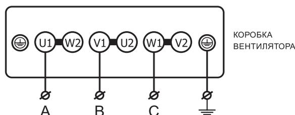
\* В вентиляторах с номинальным напряжением  $\Delta/Y$  380В/660В предусмотрена возможность запуска пониженным напряжением по схеме Y- $\Delta$ . Для получения более подробной информации по подключению, обратитесь в отдел технической поддержки.
