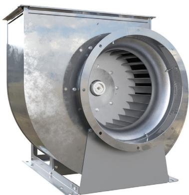
Вентиляторы серии ВРВ-ДУ для противопожарных систем дымоудаления (ППД-систем) представляют собой радиальные вентиляторы с загнутыми вперед лопатками специальной формы с рабочим колесом левого или правого вращения.
