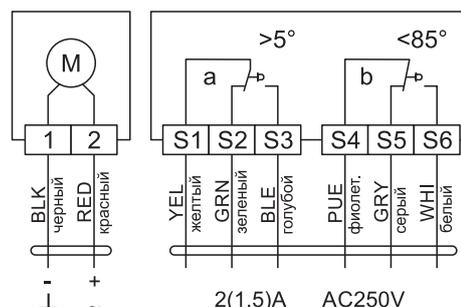
**Электрические схемы подключения клапанов O3 MC**
