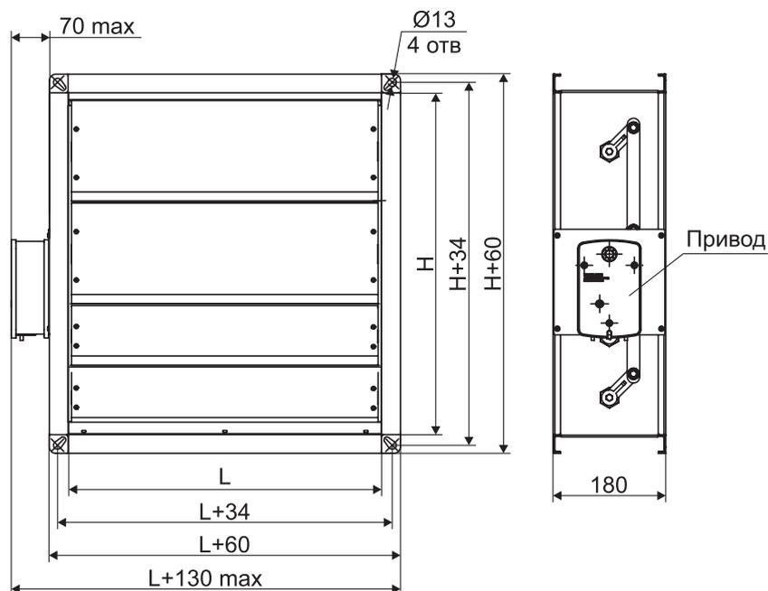
**ЗАТВОР-ДУ с приводом внутри**
