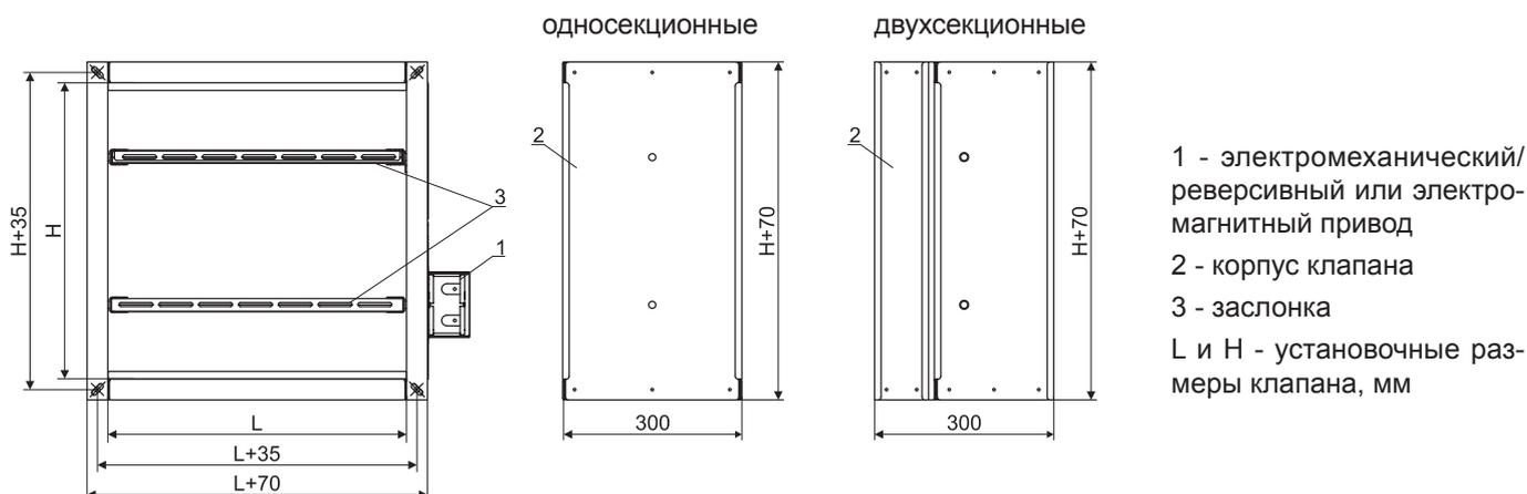
**Виды кассетного исполнения клапанов ОЗ МС-60 и ОЗ МС-90 стенового исполнения**
