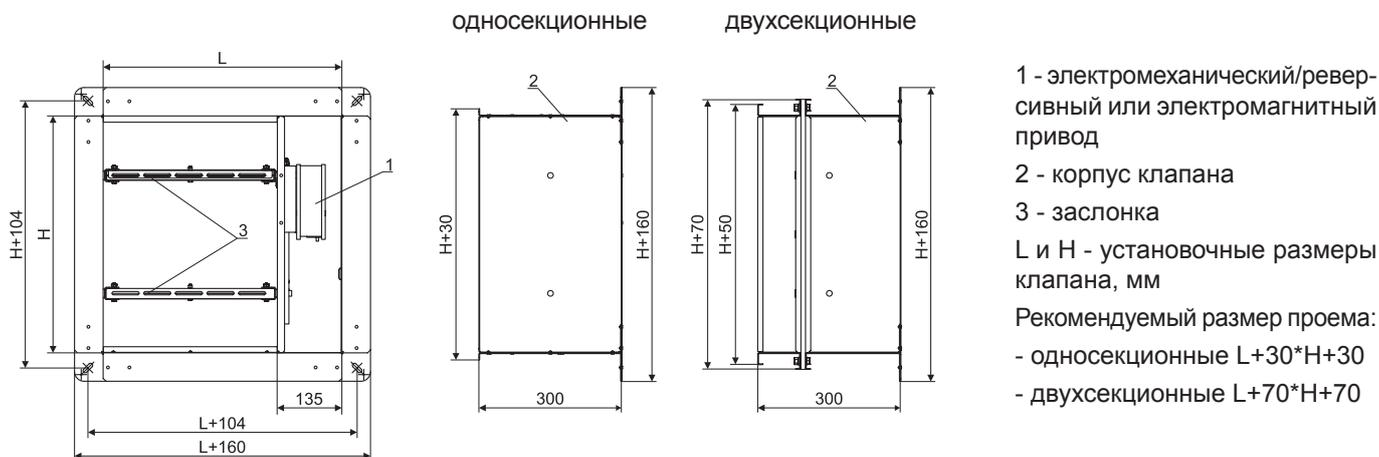
Клапан ОЗ каналный с электромеханическим/реверсивным приводом и с электромагнитным приводом
