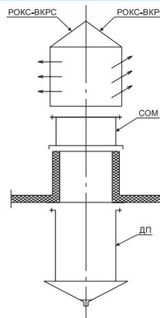
Схема установки вентилятора ВОП-20 на стакан опорный монтажный СОМ с установкой дренажного поддона
