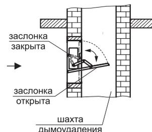
Примечание: Клапаны с электромагнитными приводами устанавливаются исключительно в вертикальной плоскости.
