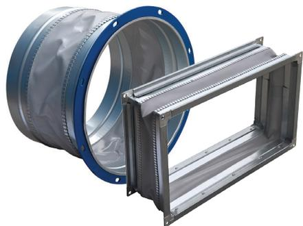
Вставки гибкие круглые и прямоугольные предназначены для предотвращения передачи вибрации от вентилятора к воздуховоду. Вставки гибкие в исполнении «дымоудаление» применяются в системах вытяжной противодымной вентиляции и способны выдерживать температуру до +400°С в течение 240 минут.
