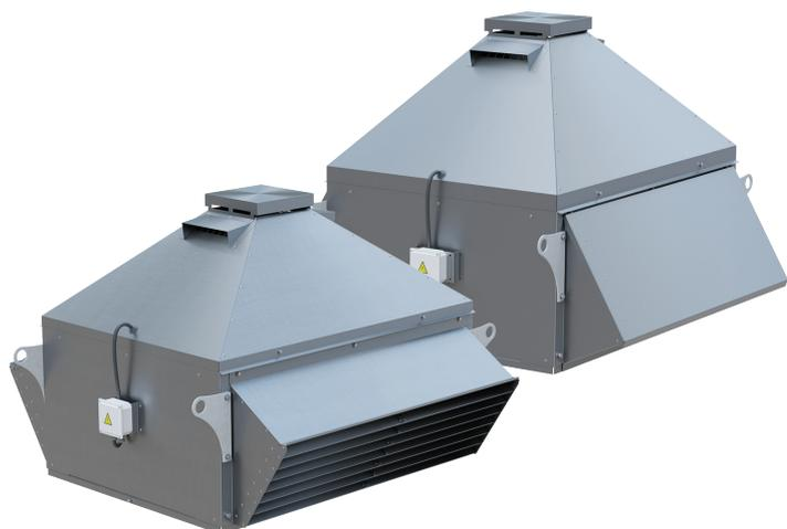
Вентиляторы крышные радиальные для противопожарных систем дымоудаления (ППД-систем) с выходом потока воздуха в стороны РОКС-ВКРС-ДУ и вверх РОКС-ВКРФ-ДУ представляют собой крышные радиальные вентиляторы низкого давления, одностороннего всасывания, с рабочими лопатками загнутыми назад, устанавливаемые на кровле здания на стаканы монтажные типа СОМ.
