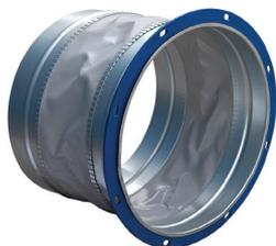
Вставки гибкие круглые предназначены для предотвращения передачи вибрации от вентилятора к воздуховоду. Вставки гибкие круглые в исполнении «дымоудаление» применяются в системах вытяжной противодымной вентиляции и способны выдерживать температуру до +400°С в течение 240 минут.
