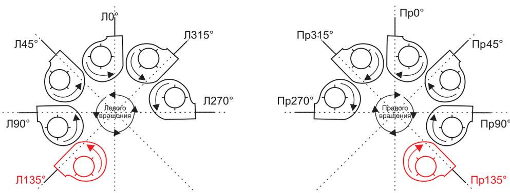
**Вентилятор правого вращения** - вентилятор, рабочее колесо которого вращается по часовой стрелке - вид со стороны всасывания.
