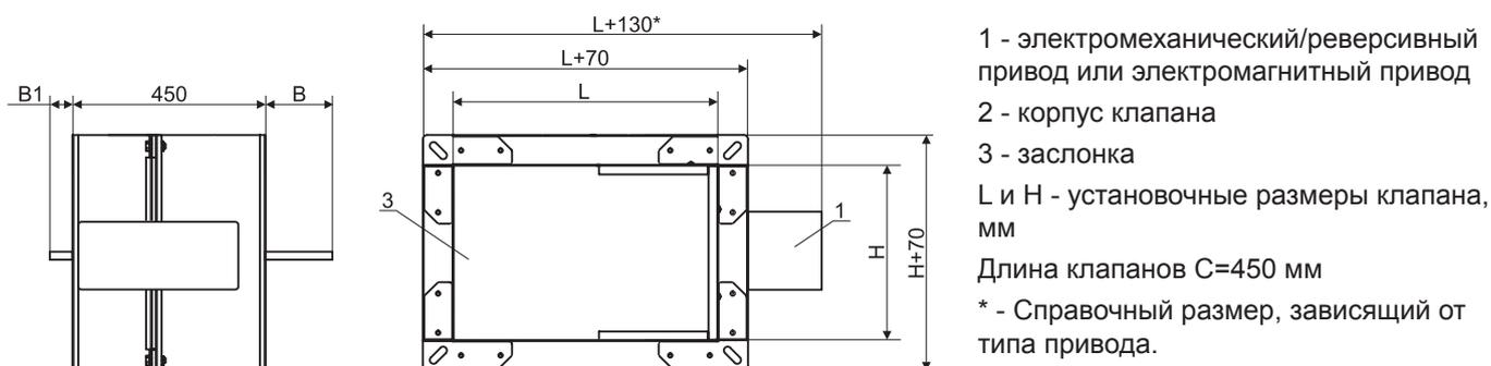
Вылет заслонки за корпус клапана прямоугольного сечения канального исполнения:
