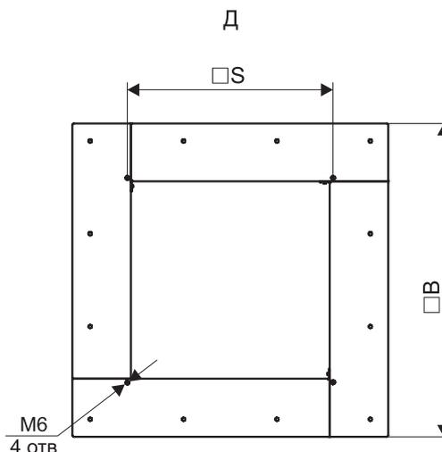
\* Стакан опорный монтажный COM-O3 укомплектован противопожарным клапаном имеющим предел огнестойкости согласно маркировке.
