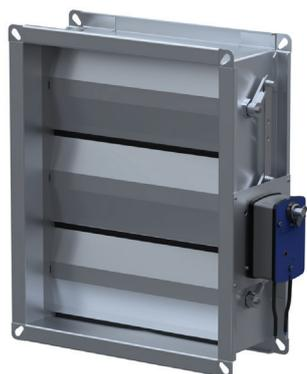
Клапан противопожарный повышенной плотности ЗАТВОР-ДУ предназначен для автоматического перекрытия вентиляционных каналов или проёмов в ограждающих строительных конструкциях зданий. Устанавливается в системах вытяжной и приточной противодымной вентиляции, а так же системах для удаления газа и дыма после пожара из помещений. Применяется в системах со статическим давлением не более 1500 Па и со скоростью воздушного потока не более 25 м/с.
