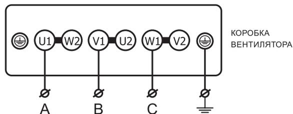
\* В вентиляторах с номинальным напряжением  $\Delta/Y$  380/660В предусмотрена возможность запуска пониженным напряжением по схеме  $Y-\Delta$ . Для получения более подробной информации по подключению, обратитесь в отдел технической поддержки.
