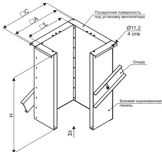
\* Стакан опорный монтажный COM-1Н-O-AF, в зависимости от заказа, в зависимости от заказа, может комплектоваться: клапаном на приток (КП) или клапаном ОЗ.
