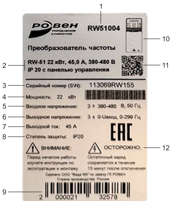
Рисунок 1.3-1 – Пример маркировки преобразователя частоты
