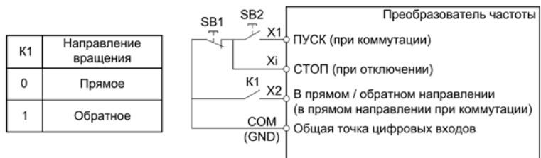
Рисунок 10.9-7 – Трёхпроводная схема управления 1
